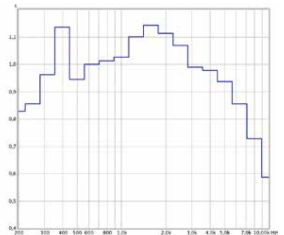
Dezelfde kamer, via de door Rivasono standaard uitgevoerde RT60-meting: veel meer details zichtbaar
